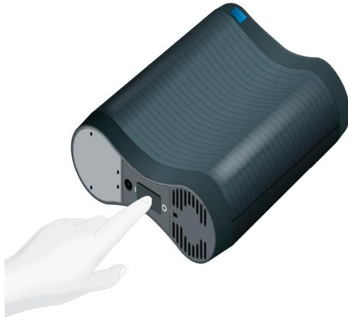
5. Espere unos 10 segundos para que el generador complete una autocomprobación. El indicador «POWER» (encendido) del panel frontal del generador se iluminará en verde, tal como se muestra a continuación.
