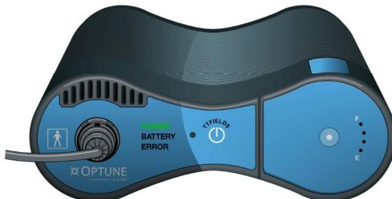
NOTA: Si se instala una batería cargada (y el generador no está conectado a un transformador de alimentación), también se iluminará en verde el indicador «BATTERY» (batería). Si el generador está conectado a un transformador de alimentación de pared, funcionará automáticamente desde dicho transformador y se apagará el indicador «BATTERY» (batería).
