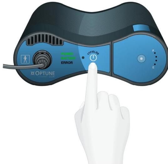
2. Schalten Sie das Gerät mit dem Netzschalter aus
