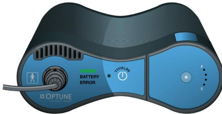
HINWEIS: Wenn ein aufgeladener Akku eingelegt wurde (und der Erzeuger nicht an ein Wandnetzteil angeschlossen ist), leuchtet die „BATTERY“ (Akku)-Anzeige ebenfalls grün. Falls der Erzeuger an ein Wandnetzteil angeschlossen ist, wird er automatisch über das Netzteil betrieben und die „BATTERY“ (Akku)-Anzeige schaltet sich aus.
