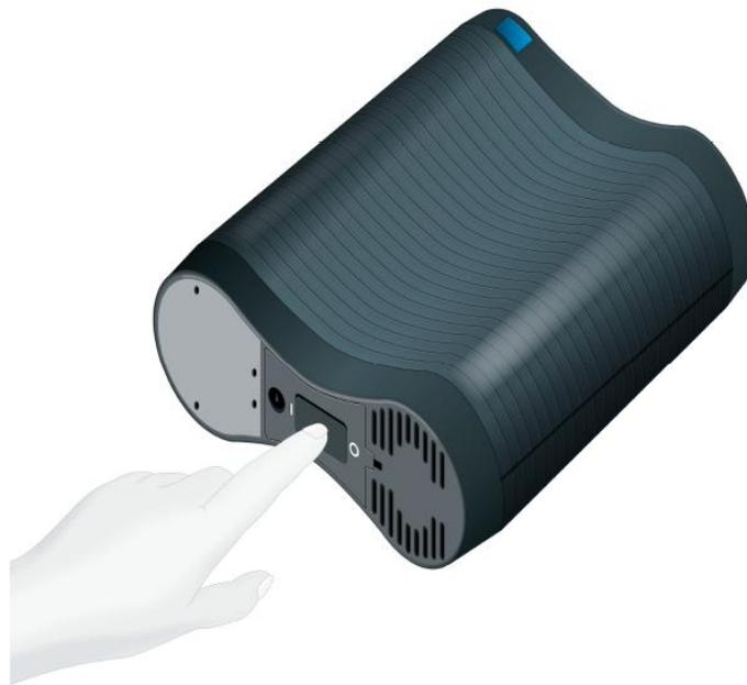
5. Warten Sie etwa 10 Sekunden, bis der Erzeuger den Selbsttest abgeschlossen hat. Die „POWER“ (Strom)-Anzeige auf der Vorderseite des Erzeugers leuchtet grün, wie unten dargestellt.
