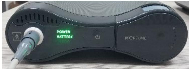
Wenn ein an das Stromnetz angeschlossenes Netzteil an das Gerät angeschlossen ist, wird das Gerät über dieses Netzteil mit Strom versorgt und die „BATTERY“ (Akku)-Anzeige leuchtet nicht auf.
