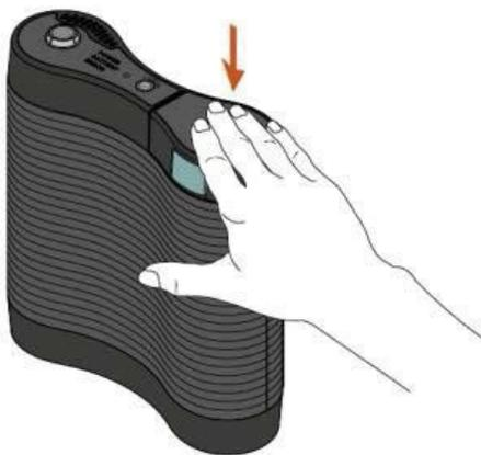
Nehmen Sie den Akku aus dem Steckplatz, indem Sie auf beide blauen Tasten an den Seiten des Akkus drücken und dann den Akku herausziehen.
