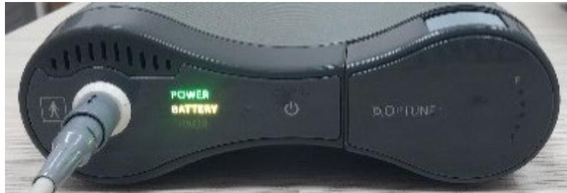
Wenn Ihr Akku leer wird (nach ca. 2-3 Stunden), ertönt das Warnsignal und die TTFIELDS-Behandlung wird abgeschaltet. Wenn das der Fall ist, wechselt die „BATTERY“ (Akku)-Anzeige auf gelb und die rote ERROR (Fehler)-Anzeige leuchtet auf. Dieses Warnsignal ist derselbe Ton, den das Gerät bei einem Fehler auslöst. Jedoch leuchten in diesem Fall sowohl die gelbe BATTERY (Akku)-Anzeige als auch die rote ERROR (Fehler)-Anzeige auf und nicht nur das rote Licht.
