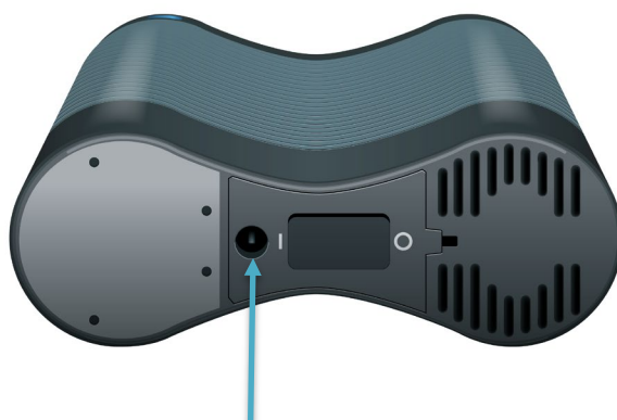
Växelströmsport intill strömbrytaren
