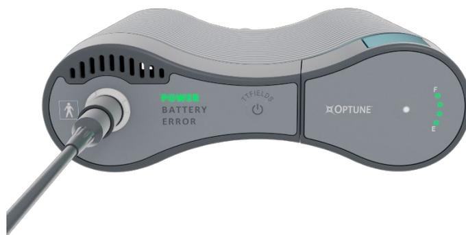
Se è installata una batteria carica e l'alimentatore non è collegato, anche la spia "Battery" (batteria) si accenderà e diventerà verde.
