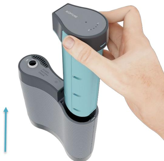
Ricaricare le batterie nel caricabatterie (vedere Sezione 15) per quattro/cinque ore. Le batterie rimarranno cariche per breve tempo se sono al di fuori del caricabatterie (ore ma non giorni). Per questo motivo, tenere sempre le altre batterie nel caricabatterie, se possibile.
