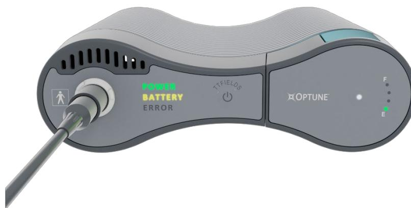
Quando la batteria si esaurisce (dopo circa 2-3 ore), verrà emesso un segnale di avviso e il trattamento con i TFields si interromperà. Quando ciò accade, la spia "Battery" (batteria) diventa gialla e si accende la spia "Error" (errore) rossa. Tuttavia, in questo caso si accendono entrambe le spie "Battery" (batteria) gialla ed "Error" (errore) rossa e non solo la spia rossa.
