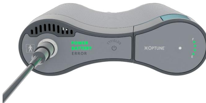
Se l'alimentatore, collegato alla rete elettrica, è inserito nel dispositivo, il dispositivo utilizzerà l'alimentatore e la spia "Battery" (batteria) non si accenderà.
