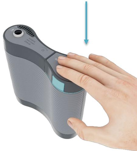
Para sacar la batería de la ranura, pulse ambos botones azules a los lados de la batería y deslícela hacia arriba hasta extraerla.
