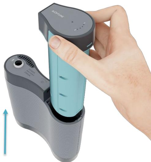
Recargue las baterías en el cargador (consulte el apartado 15) durante cuatro a cinco horas. Si no están colocadas en el cargador, las baterías permanecerán cargadas durante un período breve (horas, pero no días). Por este motivo, debe mantener las baterías adicionales en el cargador en todo momento, si es posible.
