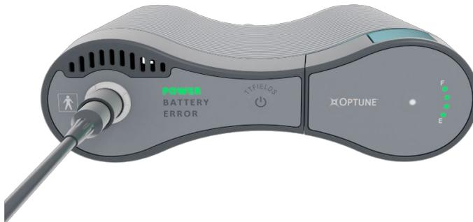
Si se ha instalado una batería cargada y el dispositivo no está enchufado a un transformador de alimentación, también se iluminará en verde el indicador «Battery» (batería).
