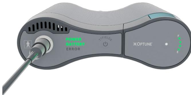
Si el dispositivo está enchufado a un transformador de alimentación conectado a la red de suministro eléctrico, el dispositivo funcionará con el transformador de alimentación y el indicador «Battery» (batería) no se iluminará.
