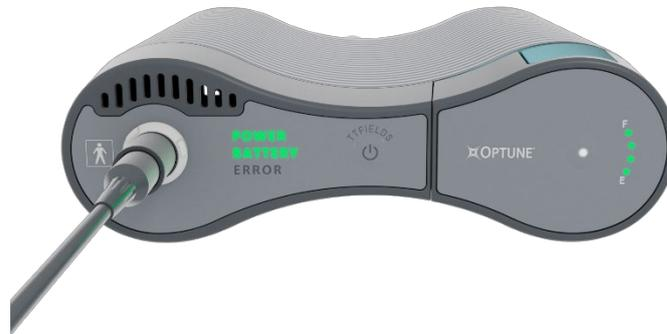
Wenn ein an das Stromnetz angeschlossenes Netzteil an das Gerät angeschlossen ist, wird das Gerät über dieses Netzteil mit Strom versorgt und die „BATTERY“ (Akku)-Anzeige leuchtet nicht auf.
