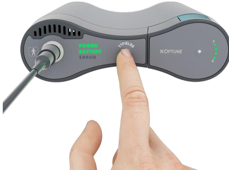
Hinweis: Die grünen, blauen und gelben Anzeigen sind in einer dunklen Umgebung dunkler und in einer hellen Umgebung heller. Die rote ERROR (Fehler)-Anzeige wird in jedem Fall hell angezeigt.
