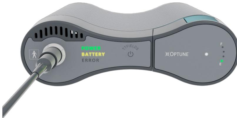
Wenn Ihr Akku leer wird (nach ca. 2-3 Stunden), ertönt das Warnsignal und die TTFields-Behandlung wird abgeschaltet. Wenn das der Fall ist, wechselt die „BATTERY“ (Akku)-Anzeige auf gelb und die rote ERROR (Fehler)-Anzeige leuchtet auf. Jedoch leuchten in diesem Fall sowohl die gelbe BATTERY (Akku)-Anzeige als auch die rote ERROR (Fehler)-Anzeige auf und nicht nur das rote Licht.
