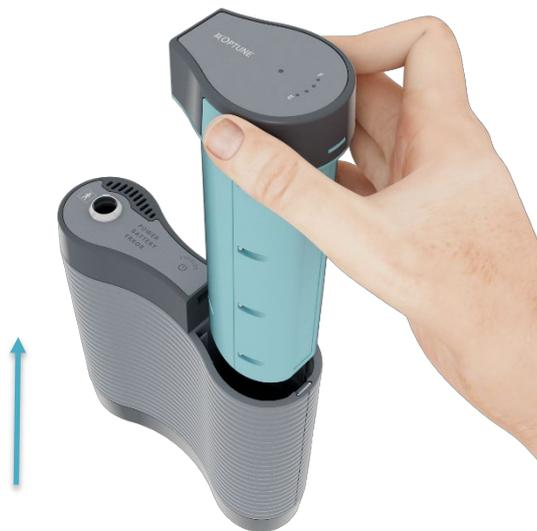
Laden Sie die Akkus im Ladegerät (siehe Abschnitt 15) vier bis fünf Stunden lang auf. Die Akkus bleiben geladen, wenn sie für kurze Zeit aus dem Ladegerät genommen werden (Stunden, aber nicht Tage). Aus diesem Grund sollten Sie die Ersatzakkus sofern möglich immer im Ladegerät lassen.
