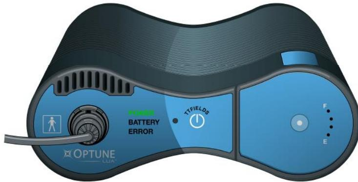
HINWEIS: Wenn ein aufgeladener Akku eingelegt wurde (und das Gerät nicht an ein Wandnetzteil angeschlossen ist), leuchtet die „BATTERY“ (Akku)-Anzeige grün. Falls das Gerät an ein Wandnetzteil angeschlossen ist, wird das Gerät automatisch über das Netzteil betrieben und die „BATTERY“ (Akku)-Anzeige schaltet sich aus.
