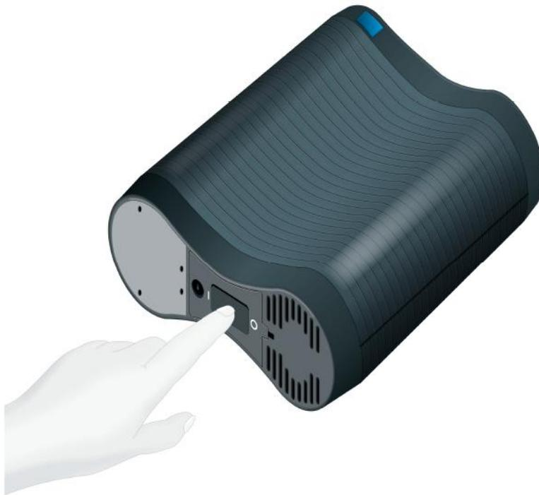
5. Warten Sie etwa 10 Sekunden, bis der Feldgenerator den Selbsttest abgeschlossen hat und die „POWER“ (Strom)-Anzeige auf der Vorderseite des Feldgenerators grün leuchtet (siehe unten).
