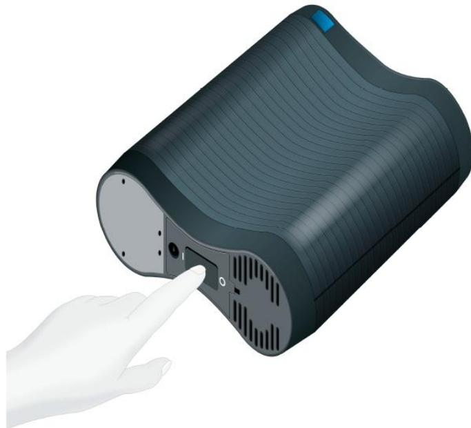
5. Aguarde cerca de 10 segundos para que o gerador conclua a autoverificação. O indicador “POWER” (ALIMENTAÇÃO) do painel frontal do gerador acende a verde, conforme se mostra abaixo.
