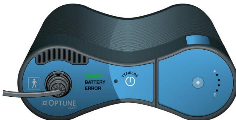
NOTA: Se uma bateria carregada estiver instalada (e o gerador não estiver ligado ao alimentador de corrente de parede), o indicador “BATTERY” (BATERIA) também fica verde. Se o gerador estiver ligado ao alimentador de corrente de parede, funcionará automaticamente a partir do alimentador de corrente e o indicador “BATTERY” (BATERIA) apaga-se.
