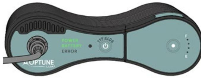
Active los TFields pulsando el botón ON/OFF (encendido/apagado) de los TFields.
