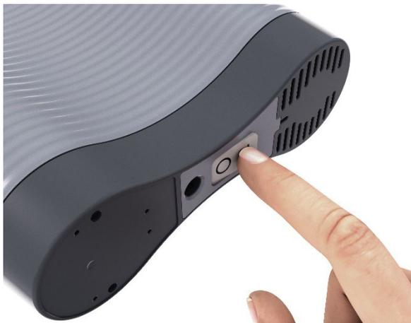
Espera unos 10 segundos para que se complete la autocomprobación, hasta que se ilumine el indicador «POWER» (encendido) en verde
