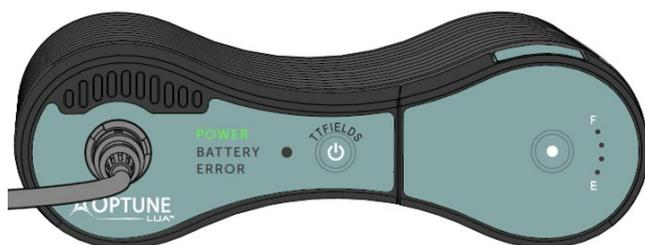
**NOTA:** se è installata una batteria carica (e l'alimentatore non è collegato), si illuminerà la spia verde "BATTERY" (batteria). Se il dispositivo è collegato a un alimentatore, funzionerà attraverso di esso e la spia "BATTERY" (batteria) si spegnerà.
