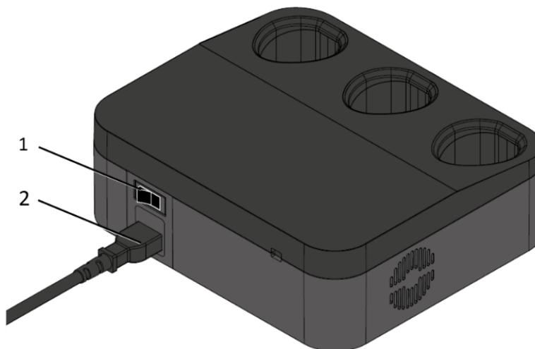
Vista traseira do carregador de baterias mostrando o interruptor de alimentação e o local de ligação do cabo de alimentação
