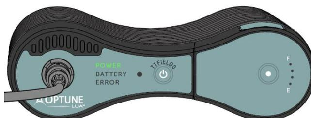
**NOTA:** Se uma bateria carregada estiver instalada (e não estiver ligado ao alimentador de corrente), o indicador “BATTERY” (BATERIA) verde acende-se. Se o dispositivo estiver ligado ao alimentador de corrente, funcionará a partir do alimentador de corrente e o indicador “BATTERY” (BATERIA) apaga-se.
