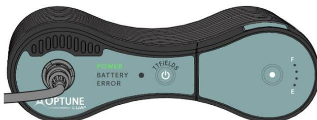
**REMARQUE :** si une batterie chargée est installée (et qu'aucun bloc d'alimentation n'est connecté), le voyant « BATTERY » (BATTERIE) vert s'allume. Si le dispositif est connecté au bloc
