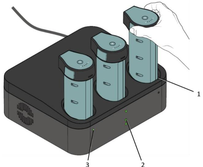
Vue avant du chargeur de batteries montrant comment les batteries sont insérées dans le chargeur
