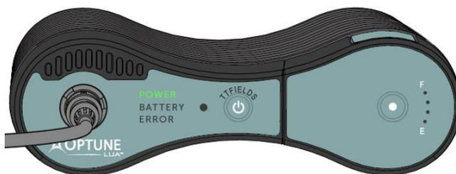
**NOTA:** Si se instala una batería cargada (y no se conecta ningún transformador de alimentación), se ilumina el indicador «BATTERY» (batería) en verde. Si el dispositivo está conectado al transformador de alimentación, funcionará desde dicho transformador y se apagará el indicador «BATTERY» (batería).
