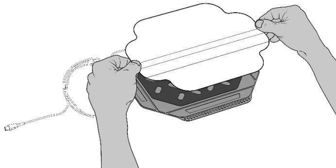
3. Comience retirando el revestimiento superior. Retire lentamente los revestimientos comenzando por la esquina superior en el medio del transductor y retire con cuidado el revestimiento hacia abajo. Despegue el revestimiento paralelo a la superficie, desde diferentes direcciones si es necesario, para asegurarse de que el transductor permanezca plano e intacto.
