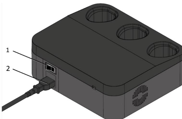
Vista trasera del cargador de baterías en la que se muestran el interruptor de encendido y el punto en que se conecta el cable de alimentación
