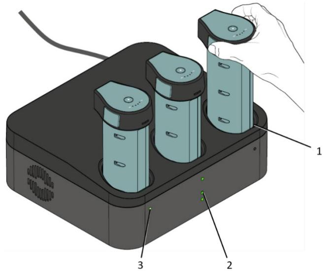
Vista frontal del cargador de baterías en la que se muestra cómo se insertan las baterías en el cargador
