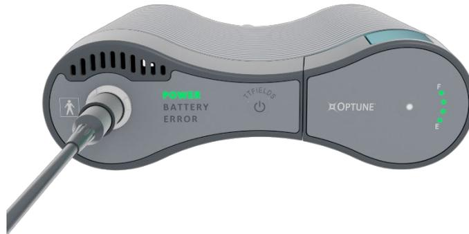
Se for colocada uma bateria carregada e o alimentador de corrente não estiver ligado, o indicador "Battery" (Bateria) também se acende a verde.
