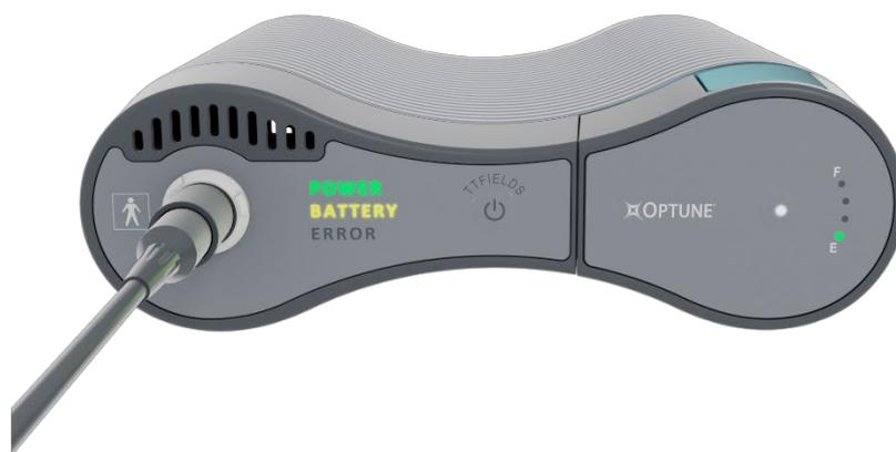
Quando a bateria ficar sem carga (após cerca de 2 a 3 horas), o sinal de aviso é emitido e o tratamento TTFIELDS é interrompido. Quando isto acontece, o indicador "Battery" (Bateria) muda para amarelo e a luz vermelha de "Error" (Erro) acende-se. Contudo, neste caso, tanto o indicador amarelo "Battery" (Bateria) como o vermelho "Error" (Erro) se acendem em vez de apenas a luz vermelha.
