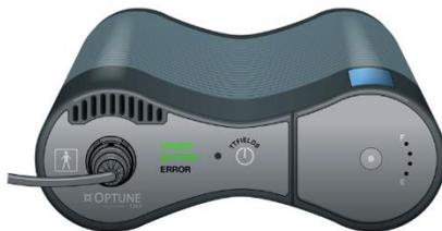
Se è installata una batteria e l'alimentatore a spina non è in uso, anche la spia "BATTERY" è illuminata in verde.
