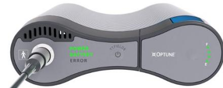
Se è installata una batteria e l'alimentatore a spina non è in uso, anche la spia "BATTERY" è illuminata in verde.
